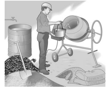
Fig. 7-5. Elaboracion en obra
