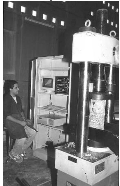
Fig. 7-9 y 7-10.. Ensayo a compresión de probetas de Hormigón
