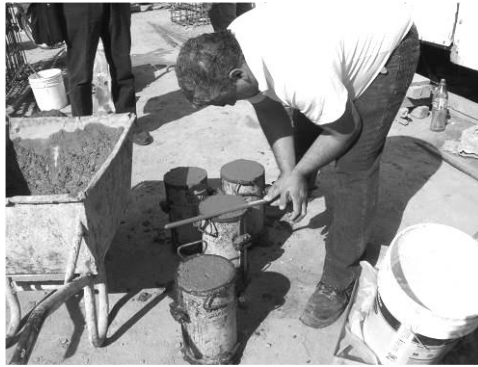
Fig. 7-9 y 7-10.. Ensayo a compresión de probetas de Hormigón
