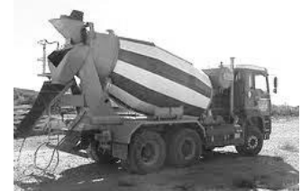
Fig. 7-6. Transporte de Hormigón elaborado en planta
