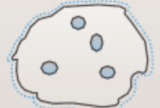
Con humedad superficial. Humedad mayor a la absorción.
