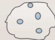
Saturado superficie seca. Humedad igual a la absorción. Poros completamente llenos de agua pero sin humedad superficial.
