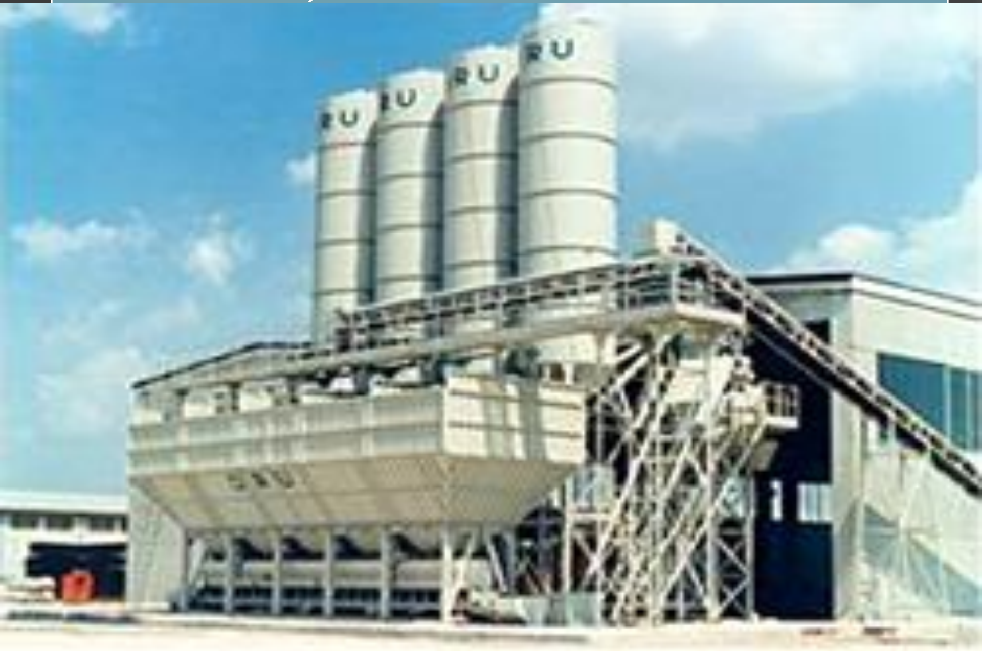
Planta dosificadora de hormigón.
