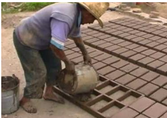
Moldeo del ladrillo en "cortaderos"
