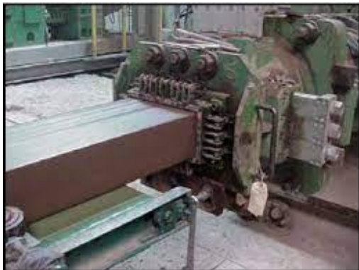
Moldeo de la pasta para bloque cerámico mediante maquina extrusora.
