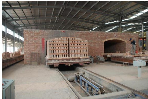
Luego del secado, cocción de bloque cerámico en hornos continuos.
